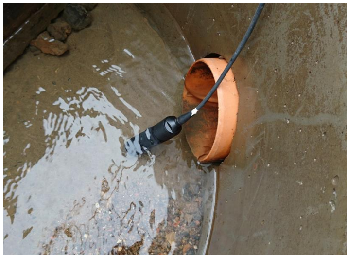
Figur 2. Eksempel på In situ måling i indløb til det konstruerede minivådområde ved Fillerup.
